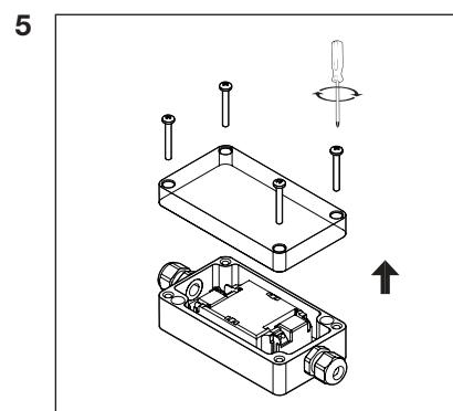
Снимите крышку блока питания.
