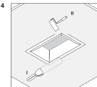
После установки следует зашпатлевать швы, покрасить потолок и гипсовый корпус светильника.
