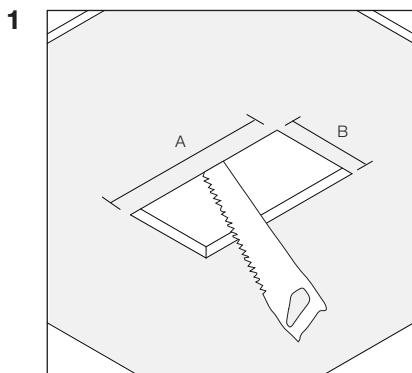
Сделайте отверстие в гипсокартонном потолке, соответствующее выбранной модели (размер AxB) (см. паспорт светильника)).
