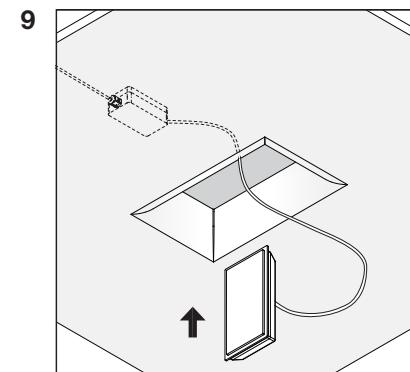
Устанавливать световой модуль в корпус следует, предварительно повернув его.
