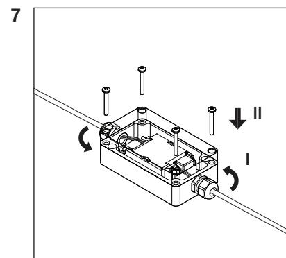
Закрепите провода и крышку блока питания.
