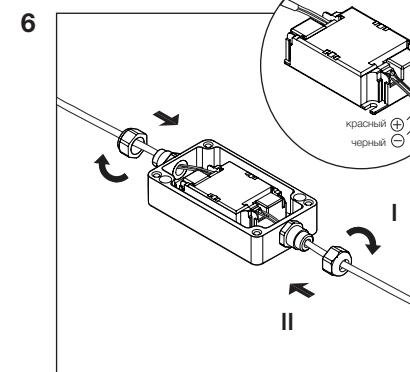
Подключите световой модуль (поз. 2) к блоку питания (поз. 3). Блок питания к электросети (см. схему подключения).
